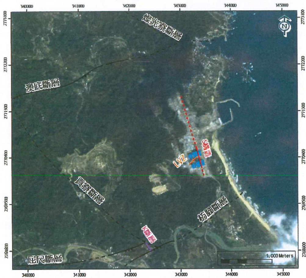
圖 4-2.1 核四廠區域主要斷層、K 斷層、S 構造與低速帶(LVZ) 相對位置圖
